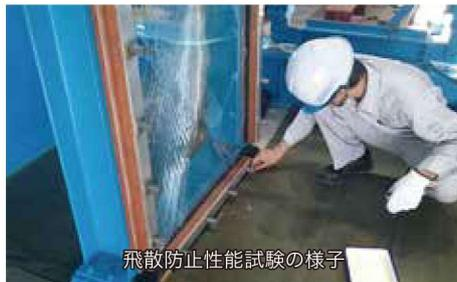
飛散防止性能試験の様子
